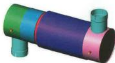
図 2.1 マフラー交換式 DPF 取付け例
